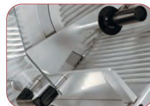
Protecciones de seguridad.
