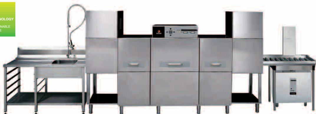
Lavavajillas ECO-370 I con mesa de prelavado MFDB-1500 LM-I, condensador de vahos CV a la entrada, túnel de secado TS a la salida, y mesa de rodillos.
