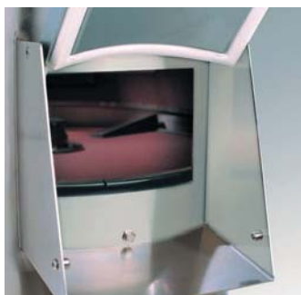
Portón de descarga.
